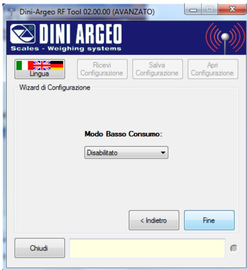
Abilitando il Modo Basso Consumo, è possibile mettere il modulo radio in stand-by quando non utilizzato e risvegliarlo quando necessario, in modo da ridurre i consumi.
