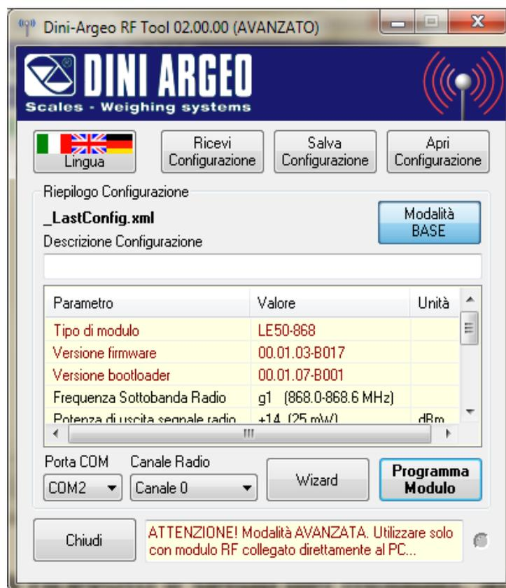
Nella quale possiamo visualizzare: tipo di modulo, versione del firmware, versione del bootloader, frequenza di sottobanda radio, potenza di uscita del segnale radio, bit-rate radio, canale radio, baud di rete su seriale, time out seriale e se è abilitata la modalità a basso consumo.
